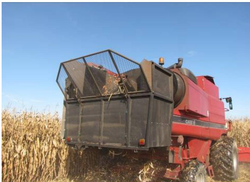
**Slika 1** Kombajn za spravilo koruznega zrnja z aksialnim rotorjem ter dodatnim sklopom za zajem klasincev
