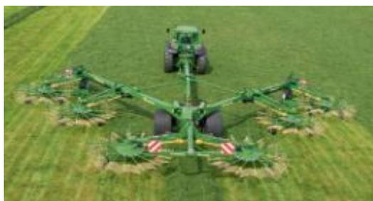
**Sl. 4** Krone Swadro 2000 rotacijske grablje sa šest rotora, radnog zahvata podesivog od 10,00 do 19,00 m
