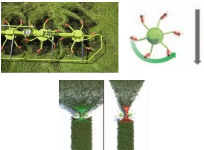
Sl. 2 Rotacijski rastresač-okretač Claas Volto 1100/1100T s Max spread koncepcijom tangencijalno postavljenih zubaca
