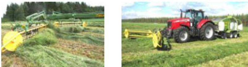
**Sl. 8** Elho grablje V-TWIN VT750 radnog zahvata od 4,50 do 7,50 m (lijevo) i V-Twin VT600 Flex radnog zahvata od 6,00 m (desno)
