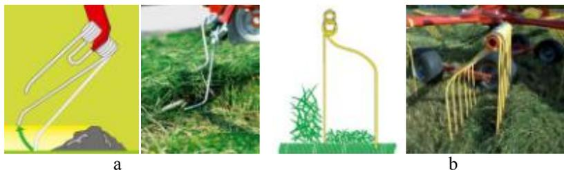
**Sl. 3** Rotacijski rastresači-okretači tvrtke Lely sa zakrivljenim opružnim zupcima (lijevo - a) i rotacijske grablje tvrtke Ziegler sa zupcima u dva reda (desno - b)
