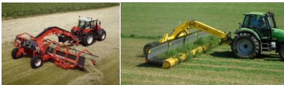
**Sl. 5** Kuhn MergeMaxx 900, trakaste grablje, radni zahvat su 9,10 i 10,50 m (lijevo) i Roc RT 1220, radni zahvat je 12,20 m (desno)
