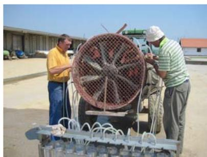
**Slika 3** Uređaj za mjerenje protoka mlaznica –*Volos II*
