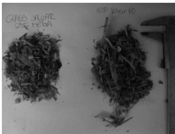
Slika 2 Dolžina rezi Class Jaguar 695 Mega (levo) in SIP Vihar 40 (desno) (Hrastel, 2008)
