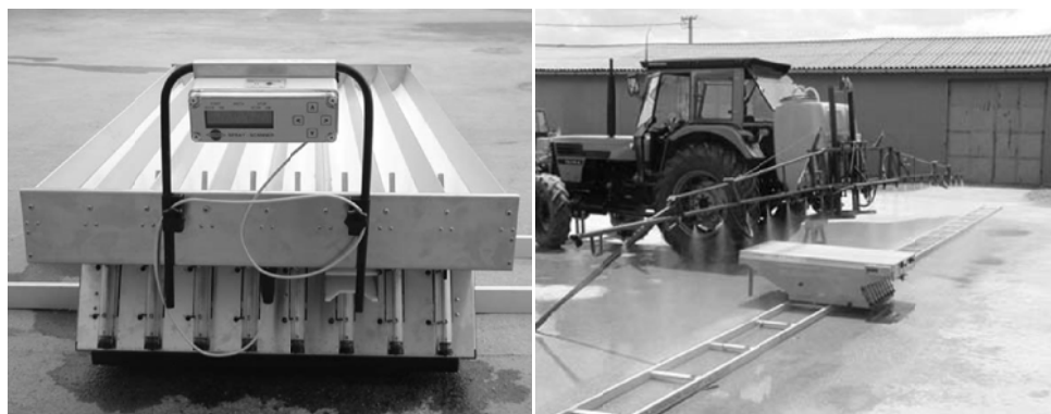
Slika 4 Ispitivanje površinske raspodjele tekućine kod nošene ratarske prskalice
