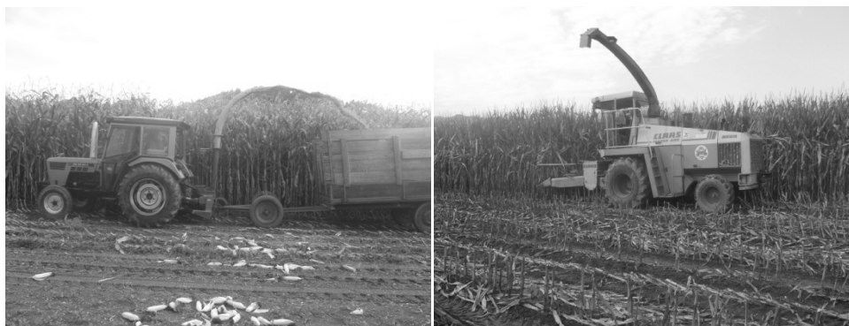
Slika 1 Enoredni kombajn SIP Vihar 40 (levo) in samohodni kombajn Class Jaguar 695 Mega (desno)
