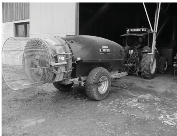
Slika 1 Raspršivač s oznakom C kod mjerenja potrebne snage za pogon preko priključnog vratila
