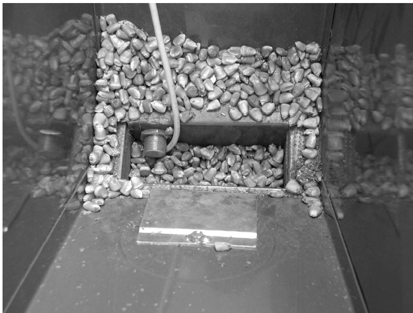
Slika 8 Količina semena ob vklopu signala pri postavitvi senzorja na dno nasipnice
