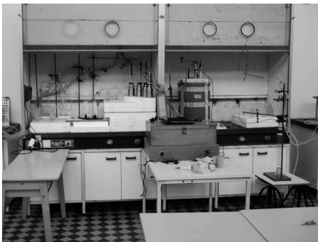
Slika 1 Eksperimentalni reaktorski sustav za kompostiranje
