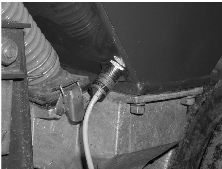
Slika 6 Kapacitivni senzor vgrajen s strani nasipnice. Stikala so bila med preskušanjem povezana z baterijsko svetilko, ki je služila kot indikator delovanja, za kapacitivni senzor pa je bila uporabljena 18 V baterija in merilnik električnih veličin MI 7043.
